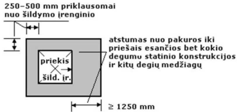
Pav. 5 Atstumo tarp šildymo įrenginio ir statinio konstrukcijos ir kitų degių medžiagų nustatymo principas
